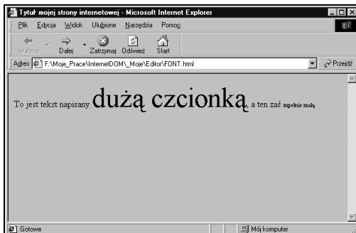
Rysunek 11.30. Znacznik <FONT> (w odróżnieniu od znaczników tytułów <Hn> ) umożliwia zmianę rozmiaru czcionki wewnątrz danej linii tekstu
