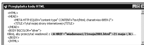
Rysunek 11.38. Przykład zdefiniowania odnośnika do konkretnego pliku
